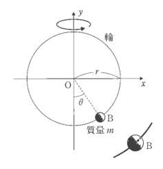
23 輪と小球Bの間に摩擦がない場合を考え る。図のように、輪が角速度の大きさωで回 転することにより、Bは $\theta = 30^{\circ}$ の位置でつり 合い止まっている。 $\omega^2$ は $\frac{g}{r}$ の何倍か。
